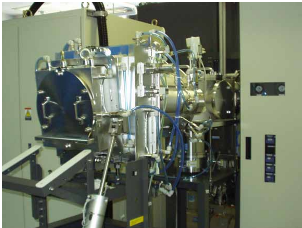
図 3. ターゲット部分 (エンドステーション部分).
