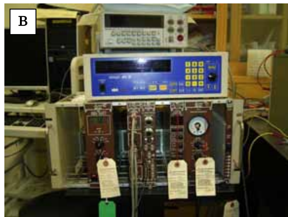
図 4. A. 左が分光器、右が光電子増倍管、手前に X-Y レコーダーが配置されている。B. 分光器の制御系。青いコントローラでグレーティングを回転させ、波長分散された光をスリットに導く。下のモジュールは光電子増倍管等にパワーを供給するためのもの。
